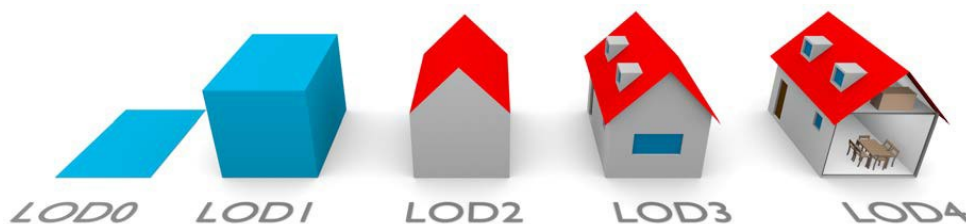
Obr. 16: Pět úrovní Level of Detail v OGC CityGML 2.0 (zdroj: Biljecki 2017)
