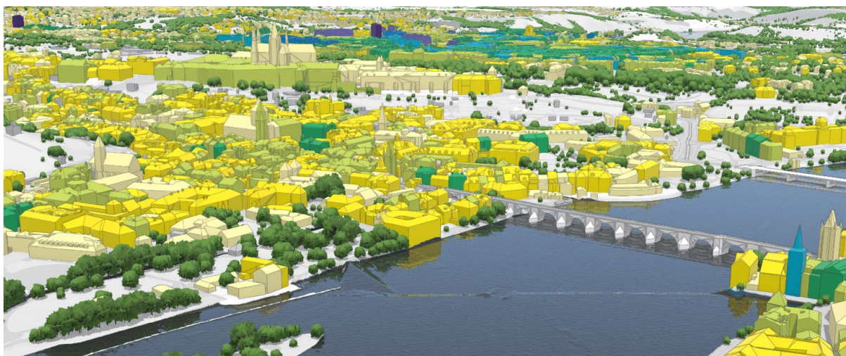
Obr. 13: 3D model Prahy v LOD2 – barva budov reprezentuje počet podlaží (zdroj: IPR Praha 2023)
