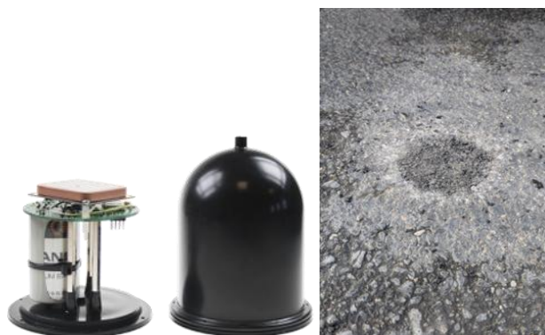
Obrázek 2 Magnetometr (Citiq s.r.o., 2021)
