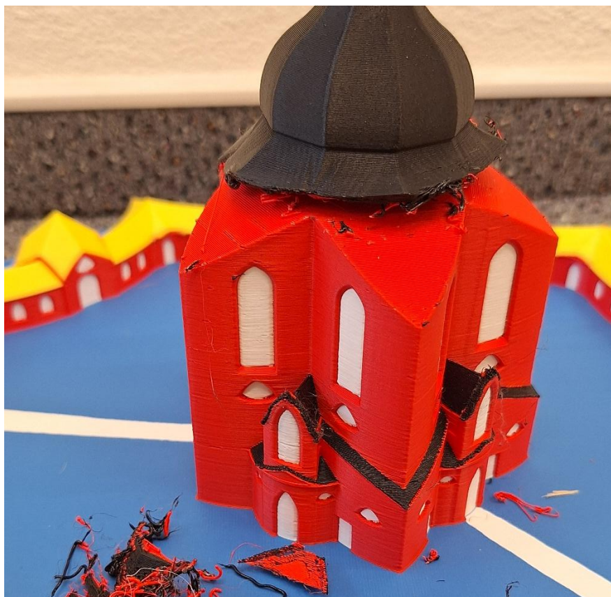
Obrázek 11: Špatně uchycené části střechy z důvodu chyby v geometrii
