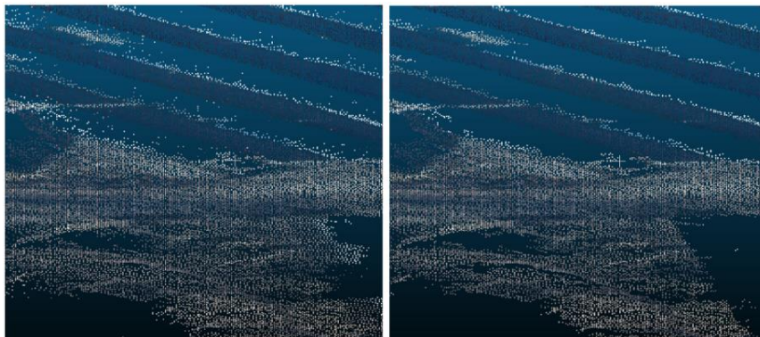
Obr. 13 Detail testovacího území před (vlevo) a po (vpravo) použití SOR filtru (zdroj: autor).
