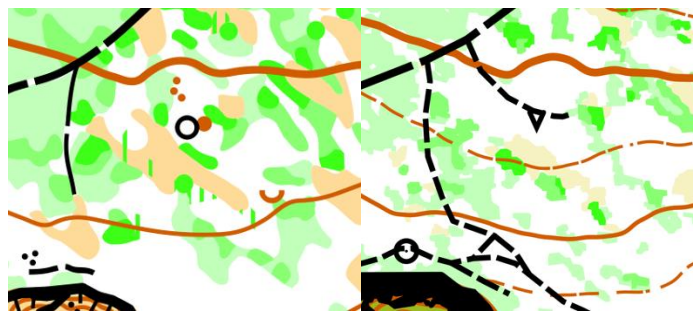
Obr. 17 Stejný objekt zaznamenaný v originále znakem 530 (vlevo) a v datech z OSM znakem 203.1 (vpravo).
