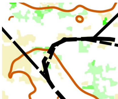
Obr. 22 Nechtěná duplikace dat při kombinaci dat OSM a ZABAGED®.
