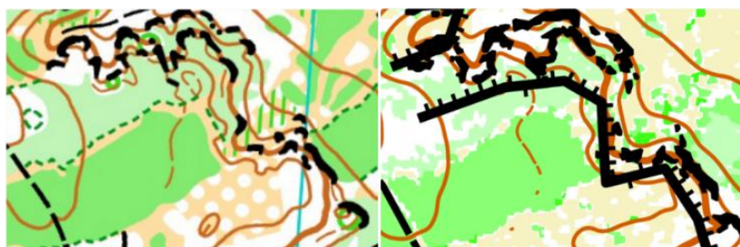
Obr. 16 originální vykreslení skal (vlevo) a kombinace OSM a DMR (vpravo).
